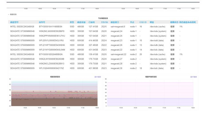
您也可以监控到集群所有节点上所有磁盘的温度以及磁盘损坏情况。
