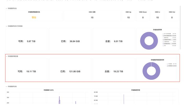
您在 **存储集群裸容量** 展示项中可以查看到可使用、已使用以及总共的数据裸容量。在右侧的圆饼图中,您也可以直观的查看集群裸容量使用率。
